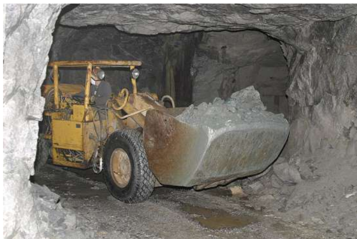
Фото 3. Відкочування відбитої руди
